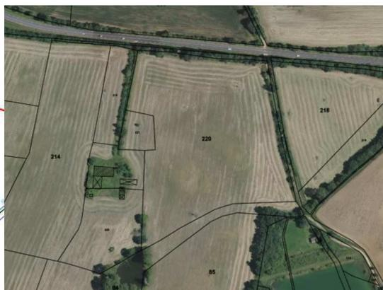
Plus loin, sur Giscaro, on est aussi en achat direct sur un terrain SAFER, terrier 170, pour 466 m<sup>2</sup> car on est en remblais avec une voirie à 3,8 m au-dessus du terrain naturel nécessitant de la place pour le talutage.
